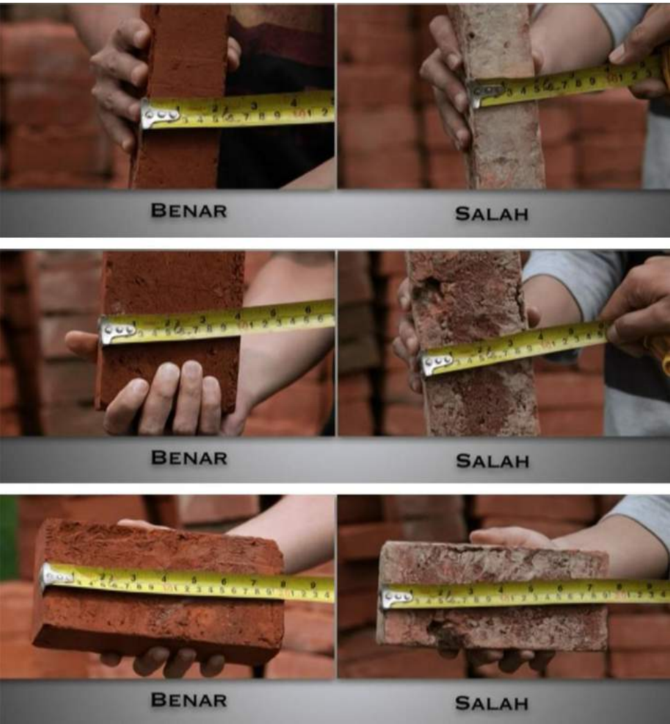
Gambar 14. Dimensi Batu Bata Yang Baik Digunakan Dalam Pembangunan
