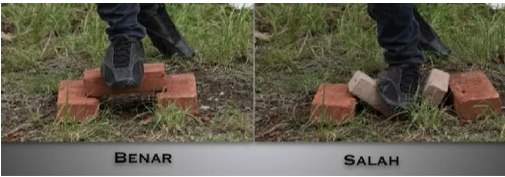
Gambar 13. Pengujian Sederhana Kekuatan Batu Bata
