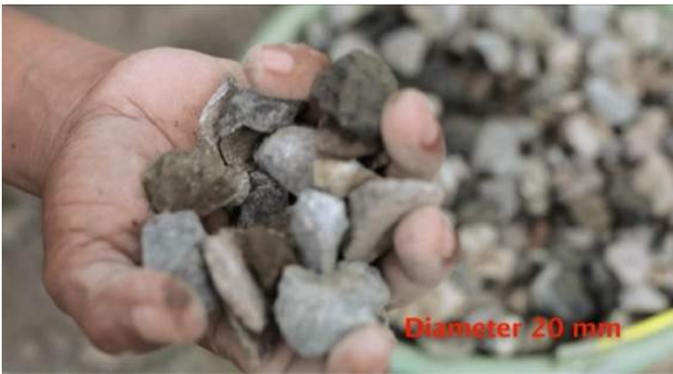
Gambar 5. Diameter Kerikil Yang Baik Untuk Campuran Beton
