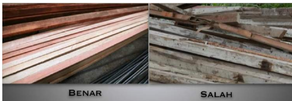
Gambar 16. Kayu Yang Baik Digunakan Dalam Pembangunan
