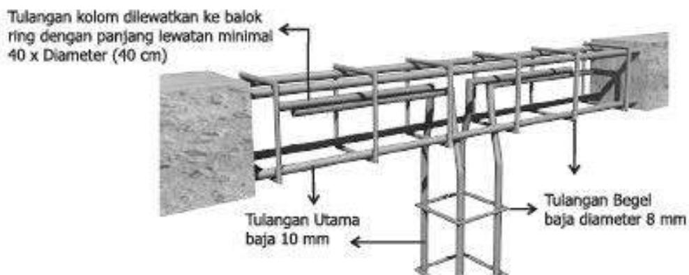
Gambar 48. Hubungan Anatar Kolom dengan Balok Keliling/ Ring
